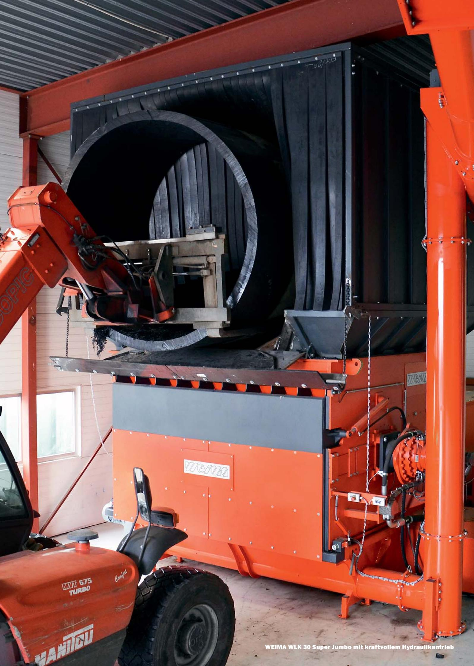
WEIMA WLK 30 Super Jumbo mit kraftvollem Hydraulikantrieb
