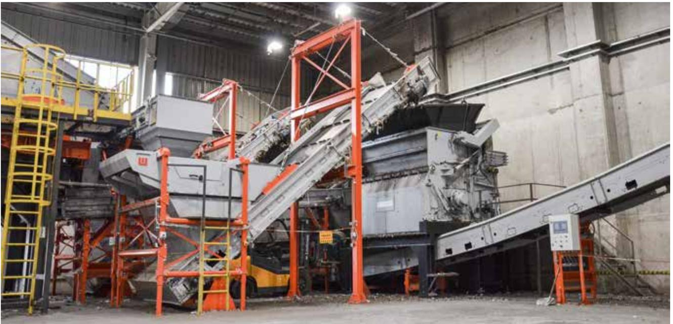
2x PowerLine 3000 mit Hydraulikantrieb, Polen
