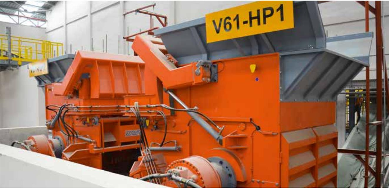
2x PreCut 2000 mit Hydraulikantrieb, Indonesien
